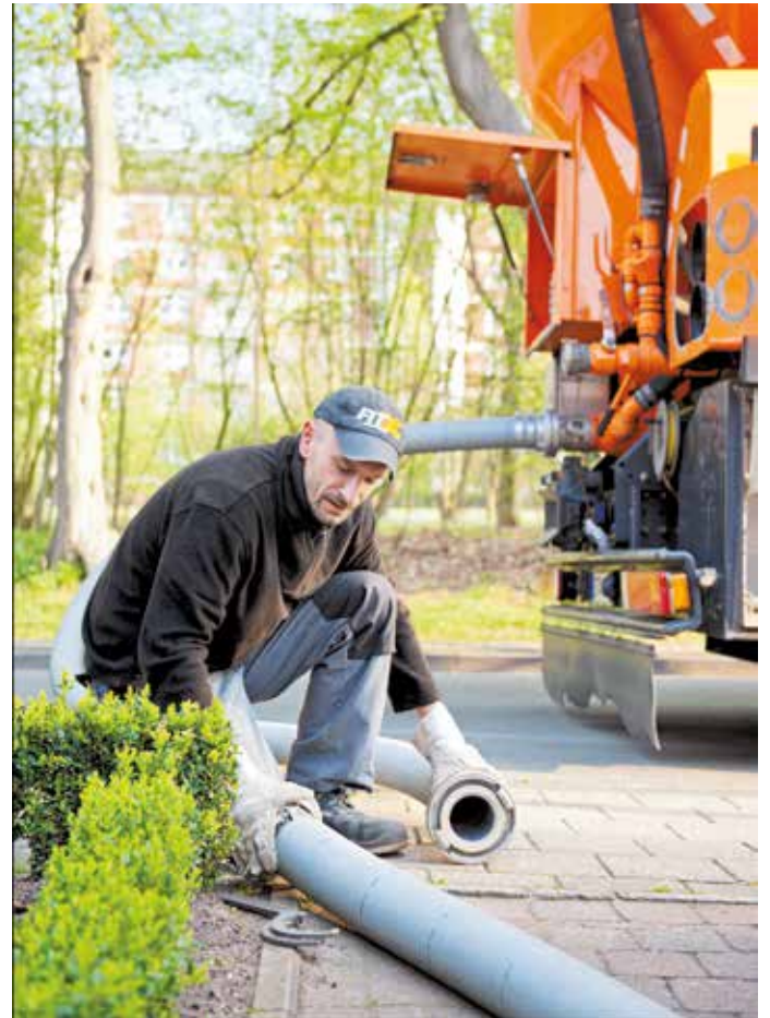
Holzpellets werden mit einem Lkw angeliefert und vom Fahrzeug aus mit Druck ins Pelletlager geblasen. Damit die kleinen Holzpresslinge dabei keinen Schaden nehmen, sind die Mitarbeiter speziell geschult und das Lager muss bestimmte Voraussetzungen erfüllen. Die Planung ist deswegen Sache eines Pelletfachbetriebs. (txn) Foto: Deutsches Pelletinstitut/txn
