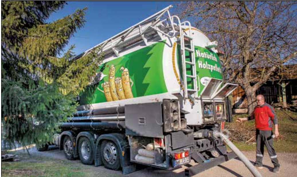
Holzpellets werden mit einem Lkw angeliefert und vom Fahrzeug aus mit Druck ins Pelletlager geblasen. Damit die kleinen Holzpresslinge dabei keinen Schaden nehmen, sind die Mitarbeiter speziell geschult und das Lager muss bestimmte Voraussetzungen erfüllen. Die Planung ist deswegen Sache eines Pelletfachbetriebs. (txn) Foto: Deutsches Pelletinstitut/txn
